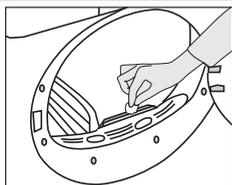
В сушильной машине установлены датчики влажности для определения сухости белья. Чтобы очистить датчики:
